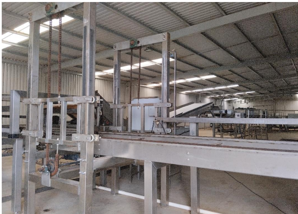
Figura 4. 12. Sistema de transportadores y volcadora - Rancho Munguía
