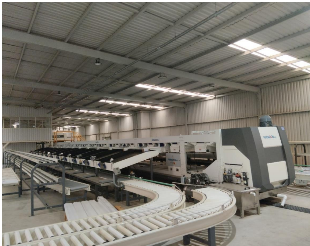
Figura 4. 9. Línea de clasificación por peso y color REEMOON - Rancho Munguía
