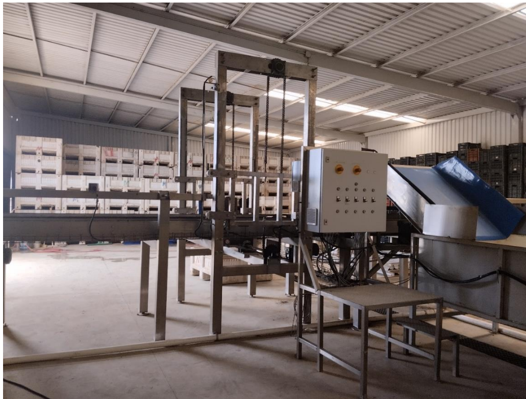
Figura 4. 15. Línea de transporte y sistema de volteo de contenedores al interior de la empacadora - Rancho Munguía
