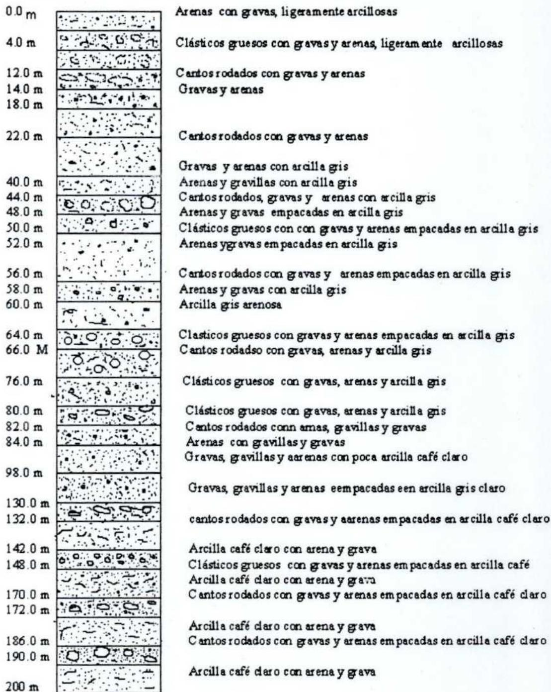
Fig. 5 Corte litológico de pozo en Calle 3a y Ocampo con datos de CNA, 1998.
